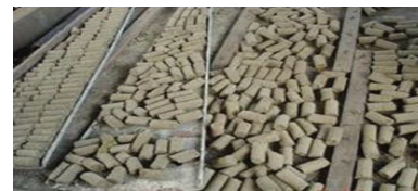
Briquette à base de balle moulue et liant effluent huile de palme
