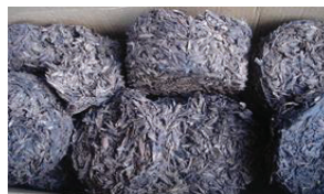
Briquette à base de balle non moulue et liant argile
